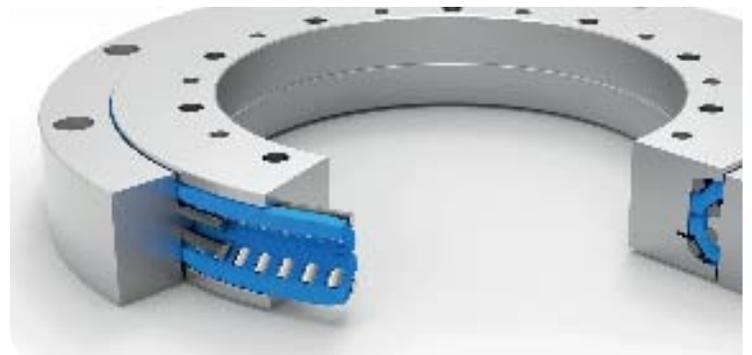
des Lagers um bis zu 50% gegenüber Kugellagern. Durch die kreuzweise Anordnung der Laufrollen können gleich hohe Lasten aus allen Richtungen aufgenommen werden. Wir unterscheiden zwei Varianten des Kreuzrollenlagers: 1-reihige Lager, bei denen die Rollen wechselweise
