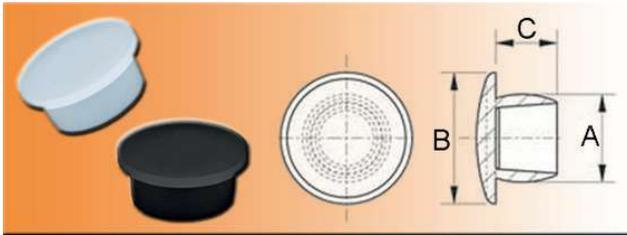
Bitte beachten Sie bei der Auswahl der Zierstopfen, daß der Schaftdurchmesser (A) etwa 0,2 bis 0,3 mm größer sein muß als die zu verschließende Bohrung.
